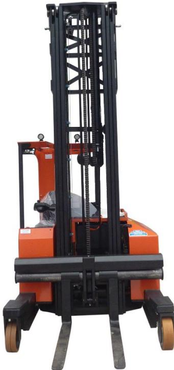
Unser Kunde besitzt einen Toyota - BT 4 - Wegeschubmaststapler Type FRE 270 mit einer **Grundtragkraft von 2.700 kg bei LSP 600 mm**. Das Fahrzeug verfügt über ein hydraulisches Zinkenverstellgerät samt Seitenverschub und dazugehöriger hydraulischer Mastüberleitungen. Die Arbeitsaufgaben im Unternehmen des Kunden erforderten die Anschaffung eines Staplers mit Triplexhubmast.
