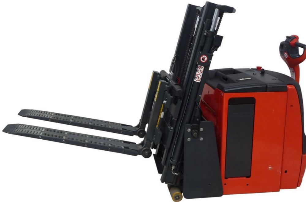
Dieser **SCHURZ Umbau auf hydraulische Mastneigung** wurde speziell auf Kundenwunsch durchgeführt. Als Grundfahrzeug diente ein Linde Deichselfahrzeug Type L 06 AC mit einer **Grundtragkraft von 600 kg** bei **LSP 600 mm**.
