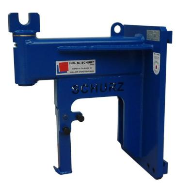
Containermanipulatoren werden eingesetzt, um die im Betrieb befindlichen Rollcontainer einfach und sicher mittels Stapler zu manipulieren. Diesmal wurde für einen unserer Kunden ein passender SCHURZ Containermanipulator für einen Yale Stapler Type GDP 50 VX, mit einer Grundtragfähigkeit von 5.000 kg bei LSP 600 mm, konstruiert und gefertigt.
