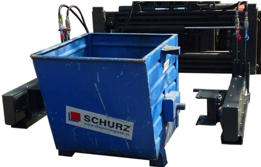
Für unseren Kunden, einen österreichischen Hersteller und Produzenten von hochwertigen tierischen Proteinen und Fetten, wurde dieses **SCHURZ Behälter Entleergerät** bereits zum wiederholten Mal konstruiert und gefertigt. Das **SCHURZ Behälterkippergerät** wurde konzipiert für die Aufnahme mit der bereits im Unternehmen vorhandenen **SCHURZ Klammergabel** und ist passend für einen Weidemann Teleskoplader Type 4070.
