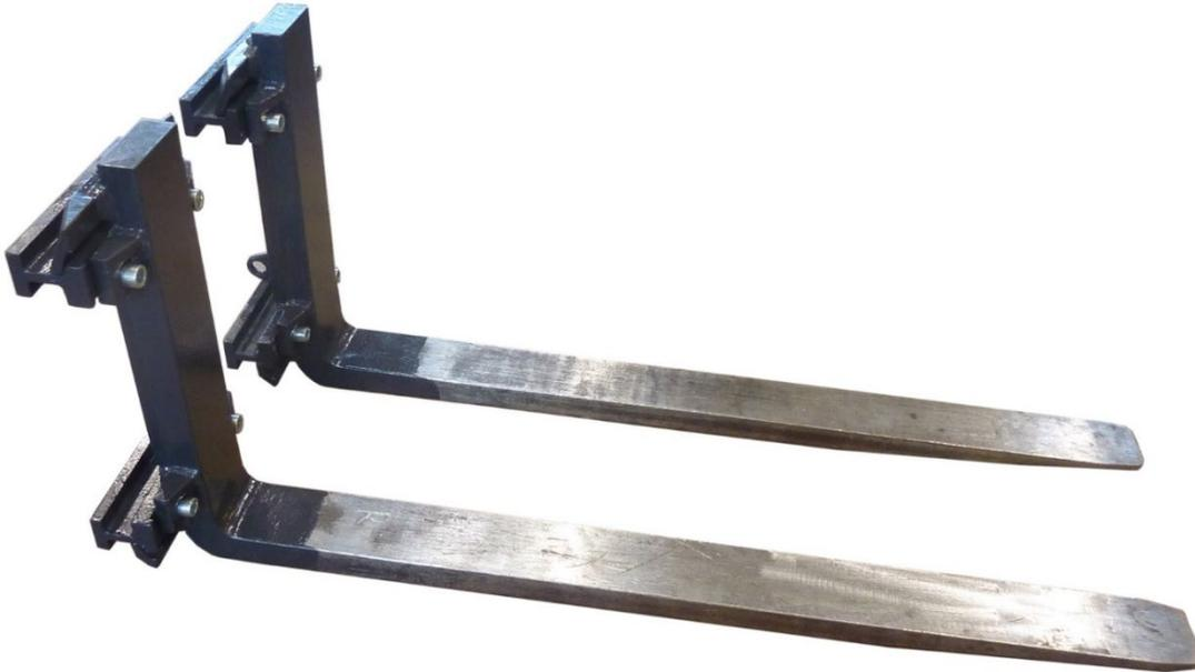
Einer unserer Kunden besitzt einen **Still RX 20 – 20 Stapler** mit einer Grundtragkraft von 2.000 kg / LSP 500 mm. Auf der Kauf Zinkenverstellung sind Gabelzinken mit der Dimension 80 x 40 – 1.200 mm montiert.
