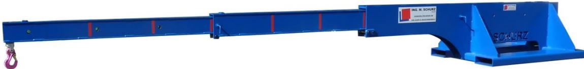
Für unseren Kunden aus der Holzindustrie wurde dieser **SCHURZ Teleskopkranarm** in der gewünschten Ausführung für einen Jungheinrich DFG 670 mit einer **Grundtragkraft von 7.000 kg bei LSP 600 mm** gefertigt.
