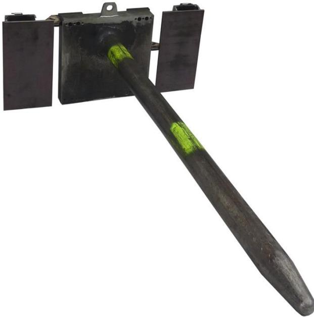
Für unseren Kunden, der im Bereich der Drahtwarenproduktion tätig ist, wurde ein vorhandener **Kaup Tragdorn** in der gewünschten Ausführung von der Fa. **ING. M. SCHURZ** umgebaut und optimiert. Der **Tragdorn** wird auf einem neu zugekauften Still RX 60- 50 / 600 mit einer Grundtragkraft von 4.990 kg bei LSP 600 mm verwendet.
