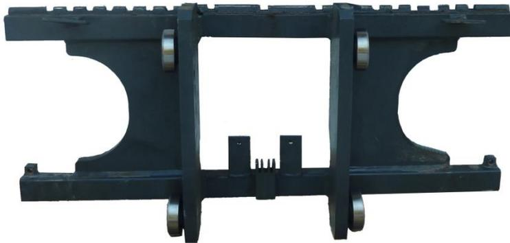
Die Reparatur eines Gabelträgers unseres Kunden war aufgrund eines Staplerunfalls erforderlich. Die beiden oberen Lagerbolzen der Trägerplattenrollen wurden verbogen. Werksseitig ist nur ein Austausch der kompletten Trägerplatte möglich.
