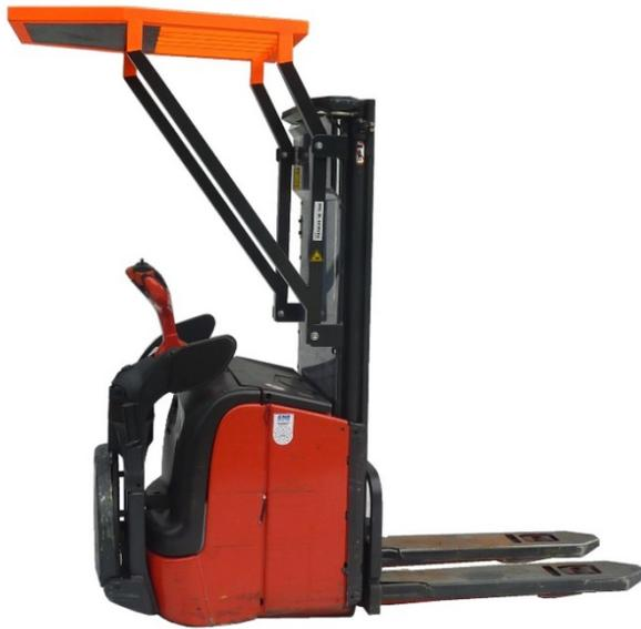
Für unseren Kunden wurde das **SCHURZ Fahrerschutzdach** passend auf einen **Linde Deichselstapler Type TGL16** mit einer **Grundtragfähigkeit von 1.600 kg** bei **LSP 600 mm**, um ca. 100 mm erhöht, um den FahrerInnen mehr Kopffreiheit im Standbereich, sowie bessere Sichtverhältnisse nach oben zu gewährleisten.
