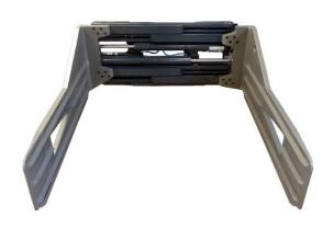
Für unseren langjährigen Kunden wurde bereits die siebte **SCHURZ** Auramo Recyclingb**allenklammer** mit integriertem Seitenverschub, passend auf einen Linde H40D Stapler mit einer Grundtragfähigkeit von 4.000 kg bei LSP 500 mm, geliefert.
