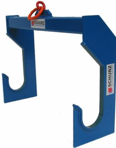
SCHURZ Waggon-Achsentransport-traverse ausgeführt für den Kranbetrieb. Die Traverse verfügt über eine Tragfähigkeit von bis zu 2000 kg. Die Aufnahmeflächen sind Polyurethane beschichtet. Damit können Waggonachsen sicher und beschädigungsfrei mittels Kran manipuliert werden.
