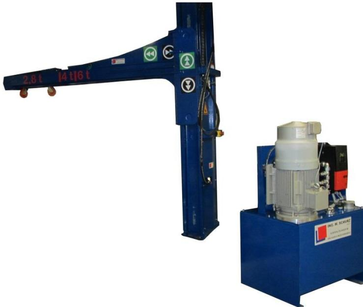
Für unseren Kunden aus der Branche elektrischer Hochspannungsprodukte wurde dieser **SCHURZ Sonder Schwenkkran** in der gewünschten Ausführung für eine **Tragfähigkeit von maximal 6.000 kg bei LSP 1.750 mm** gefertigt.
