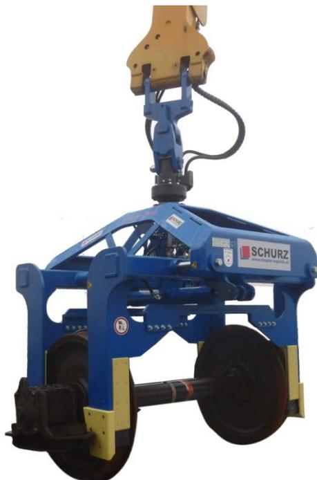
Die **SCHURZ Radsatzklammer** wurde für den Betrieb eines Liebherr Drehkranzladers Type 904 entwickelt. Die Aufnahme der Radsatzklammer erfolgt werkzeuglos, mittels **SCHURZ Schnellwechselsystem**.
