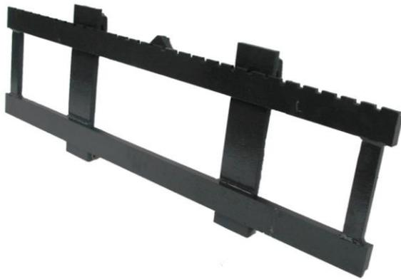
SCHURZ Schnellwechselträgerplatte mit Sonderarretierung Type 1800 für einen 1,8 to Stapler mit FEM 2A Aufhängung. Die Schnellwechselträgerplatte dient dazu, um die originale Baubreite von 970 mm auf 1500 mm zu vergrößern.
