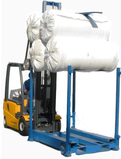
SCHURZ Schaumstoffrollenmanipulator komplett mit hydraulischer Adaptierung des Staplers und Neutypisierung eines 2,5 to Elektrostaplers.
