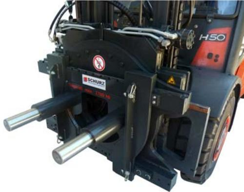
Der **SCHURZ Werkzeugmanipulator**, passend auf einen Linde H50 Stapler mit einer Grundtragfähigkeit von 5.000 kg bei LSP 500 mm dient der sicheren und einfachen Aufnahme von Schmiedewerkzeugen.
