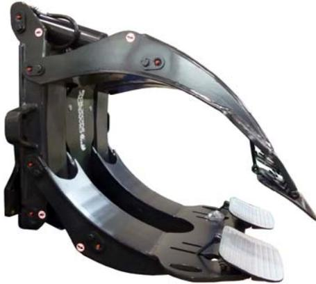
Die **SCHURZ Auramo Papierrollenklammer** in 180° drehbarer Ausführung mit einer Grundtragfähigkeit von 2.500 kg dient der sicheren und schnellen Manipulation von Papierrollen mit einem Durchmesser von 270 mm bis 1.600 mm.
