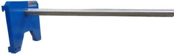
Der **SCHURZ Tragdorn** Type TD 20 passend auf einen Linde E 25 Stapler mit integriertem Seitenvershub in der Trägerplatte und einer Grundtragkraft von 2.500 kg bei LSP 500 mm dient der Manipulation von Drahtrollen mit einer Tiefe von 1.600 mm und einem Maximalgewicht von 2.000 kg.
