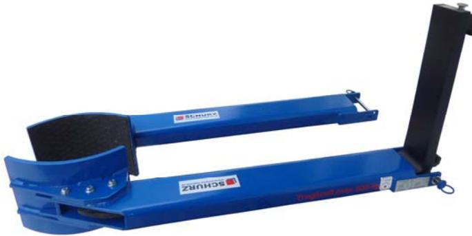
Die **SCHURZ Aufsteckarme**, passend auf einen Still Stapler Type R 60-25, ausgestattet mit einer SCHURZ Klammergabel 360° drehbar mit einer **Grundtragkraft von 2.500 kg bei LSP 500 mm.**
