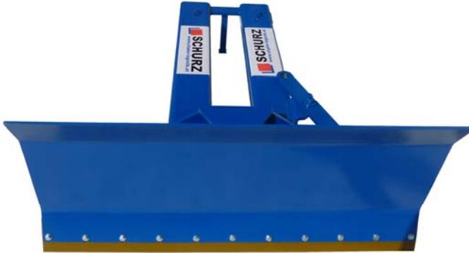
Das **SCHURZ Schneeräumschild** in **mechanisch schwenkbarer Ausführung** passend auf Linde Stapler Type E 25 mit einer **Grundtragfähigkeit von 2.500 kg bei LSP 500 mm** wird mittels Gabelzinken des Staplers an den Einfahrschuhen aufgenommen.
