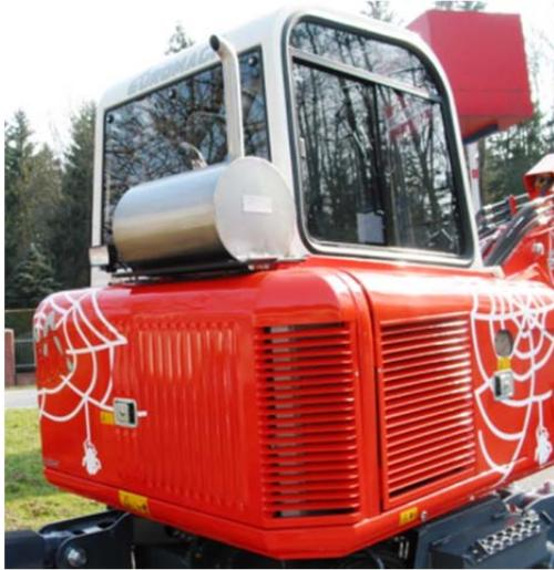
Offener **SCHURZ Partikelfilter** Type OPF 2/2 mit einfacher Staudruckkontrolle MS4E.
