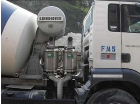
Offener **SCHURZ Partikelfilter** Type OPF 210/90 selbstregenerierend mit beschichtetem Hochtemperaturmonolith in Doppelausführung. Aufgebaut auf einem MAN LKW Type TGA 26.310 mit einer Motorleistung von 228kW bei 1.900 UPM und einem Hubraum von 10.000 ccm.
