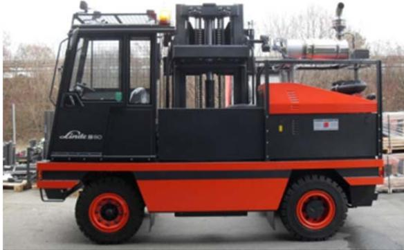
**SCHURZ Partikelfilter** Type PFS 55 DB mit hochtemperaturfestem Monolith für Schnellreinbrennung mittels Dieselbrenner. Aufgebaut auf einem Linde Dieselstapler Type S 60 mit einer Motorleistung von 63 kW bei 2.600 UPM und einem Hubraum von 3.300 ccm.
