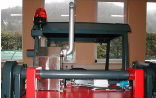
**SCHURZ Partikelfilter** Type PFL 2 ohne Katalysator für eine Kehmaschine mit einer Motorleistung von 10,4 kW.
