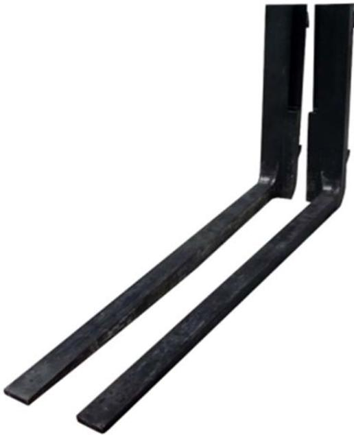
Die **SCHURZ Sondergabelzinken** für einen Sonderdeichselstapler mit der Dimension 150 x 65 x 1.400 mm am Rücken und 120 x 65 x 1.400 mm auf der Tragfläche wurden im Bereich der Außengabeln am Rücken zur Aufnahme von Sonderpaletten zusätzlich gefräst.
