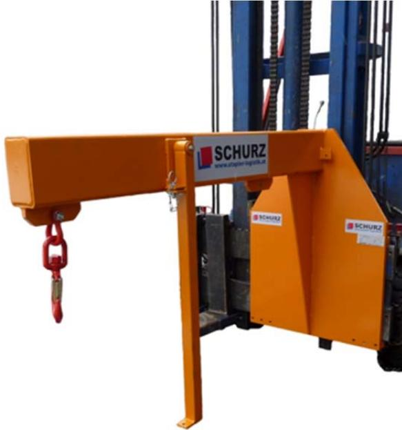
**SCHURZ Kranausleger**, passend auf einen Still Stapler Type RX 60-50 mit einer Grundtragfähigkeit von 5.000 kg bei LSP 500 mm. Mit dem Kranausleger werden in einer LKW-Produktion die Fahrzeuge in einer Halle angehoben und zum nächsten Produktionsschritt verschoben.
