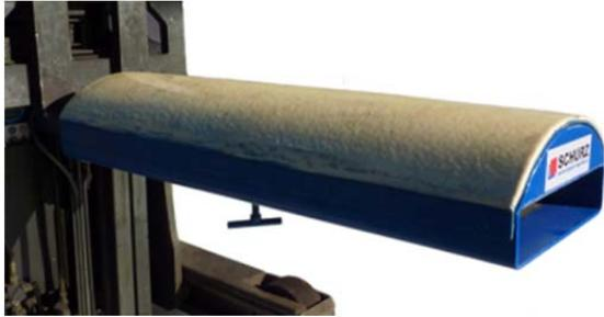
**SCHURZ Coilträger** mit Polyurethan-Sprühbeschichtung zum Transport von Blechcoils mit einem maximalen Gesamtgewicht von 8 t. Aufnahme mittels beider Staplergabelzinken.
