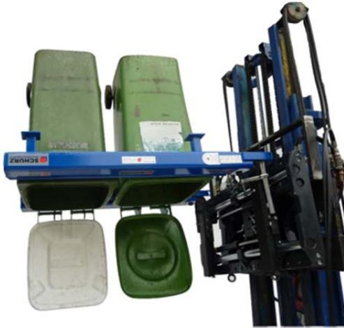
Die **SCHURZ Aufsteckschuhe zur Kübelentleerung** wurden zur Aufnahme und Entleerung von 240l PVC Mistkübeln mit Klappdeckel konstruiert. Die Aufsteckschuhe des Entleergeräts werden einfach mittels einer vorhandenen drehbaren Klammerngabel aufgenommen und werkzeuglos mit **SCHURZ Schnellverschlüssen** gesichert.
