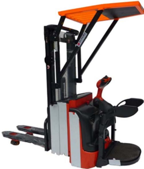
Das **SCHURZ Fahrerschutzdach**, konstruiert für einen Linde Deichselhochhubwagen.
