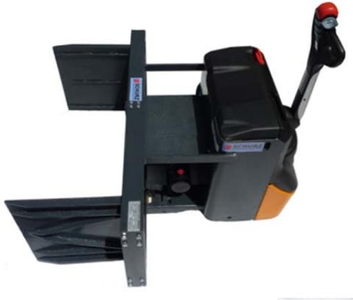
**SCHURZ Umbau** eines elektrischen Palettenhubwagens mit einer Tragfähigkeit von 1.400 kg / LSP 600 mm. Die vorhandene **SCHURZ Ballenklammer** (Baujahr 1990) und das zusätzliche Hydraulikaggregat inklusive Steuerung wurden von einem Altfahrzeug auf das Neufahrzeug umgebaut.
